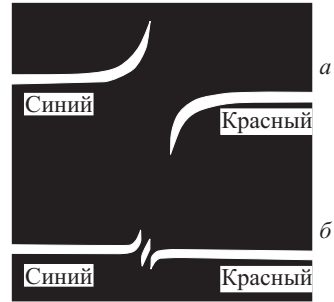
Рис. 28.5. Аномальная дисперсия в парах натрия: а — при значительной плотности пара обе линии поглощения натрия (дублет натрия) сливаются в полосу; б — при небольшой плотности пара обе линии дублета разделены
