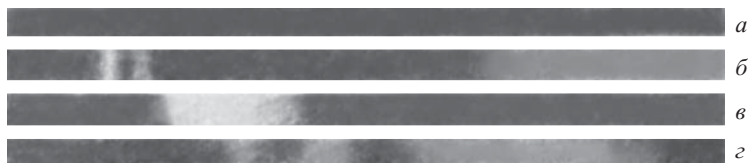
Рис. 28.15. Спектры поглощения растворов различных веществ (негатив): a — сплошной спектр источника; б — спектр поглощения азотнокислого неодима; в — спектр поглощения родамина B ; г — спектр поглощения марганцевокислого калия
